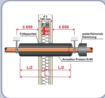
In Leichtbauwänden F-90 wird Armaflex Protect R-90 mittig eingebaut. Der Ringspaltverschluss erfolgt innerhalb der Dämmebene mit Stopfwohle, der Verschluss zur Beplankung mit bauüblichem Füllspachtel. Zusätzliche Streifen oder Schutzdämmungen sind nicht erforderlich.
