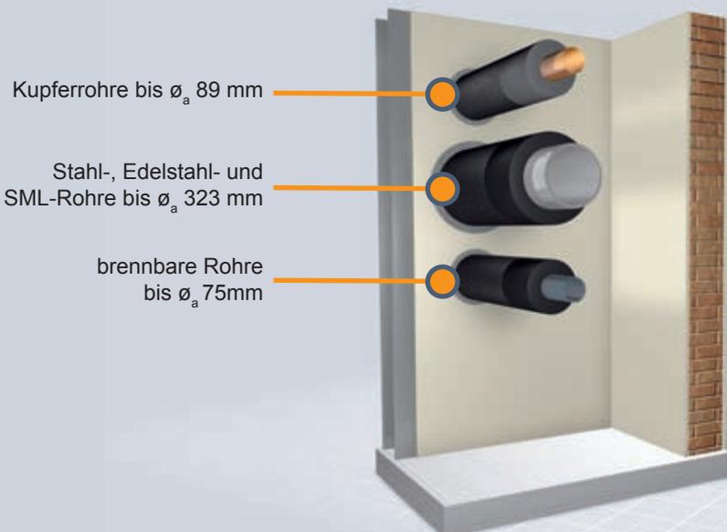
Dank der im Brandfall aufschäumenden Wirkung können mit dem neuen Armaflex Protect R-90 neben Kupfer-, Stahl-, Edelstahl- und SML-Rohren auch brennbare Versorgungsleitungen wie z.B. Mehrschichtverbundrohre, PE-, PE-HD-, PP- oder PVC-Rohre sicher abgeschottet werden.
