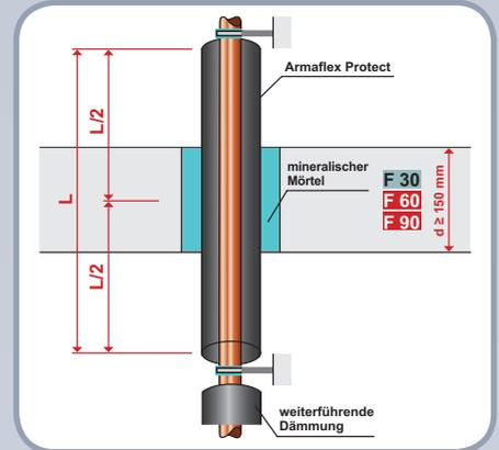
Auch bei Deckendurchführungen kann Armaflex Protect R-90 mittig eingebaut werden. Die Restöffnung im Durchbruch oder der Kernbohrung wird mit mineralischem Mörtel verschlossen.
