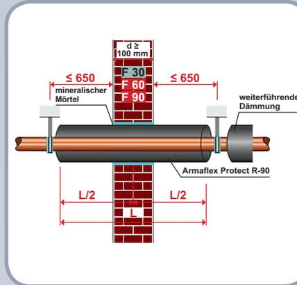
In Massivwänden F-90 wird Armaflex Protect R-90 mittig eingebaut. Der Verschluss der Restöffnung erfolgt mit bauüblichem, mineralischem Mörtel. Zusätzliche Streifen sind nicht erforderlich!
