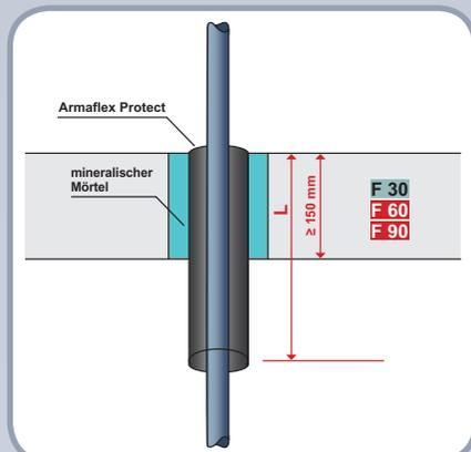
Wenn oberhalb der Decke keine Dämmung erforderlich oder möglich ist, kann Armaflex Protect R-90 auch unterseitig eingebaut werden. So können z.B. Heizkörperanbindungen einfach und sicher abgeschottet werden.
